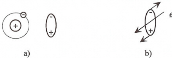
Fig. 1.4 – Polarizzazione dell'atomo (a) e polarizzazione dovuta all'applicazione di un campo elettrico \underline{e} (b).
